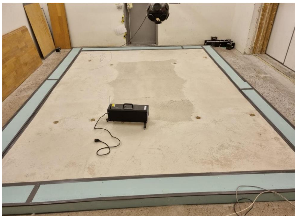
Figur 9. Provobjekt monterat i provöppning.
